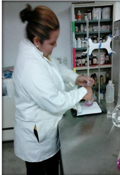
Figura10. Determinación de Calcio y Magnesio método de titulación EDTA.
