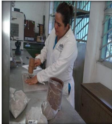
Figura. 7 Pulverizado y tamizado de muestra de suelo seco
