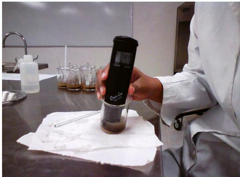
Foto 6: Medición del pH por el método electrométrico, Laboratorio de Recursos Naturales, UQROO. Daniel May, 2011.
