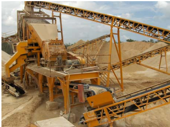
Figura 2.12 Trituración secundaria y lavado de material
