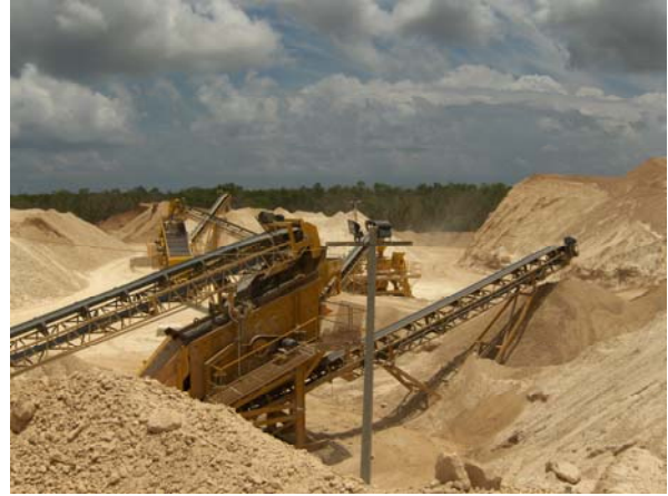
Figura 2.11 Cribado de material residual y producción de polvin
