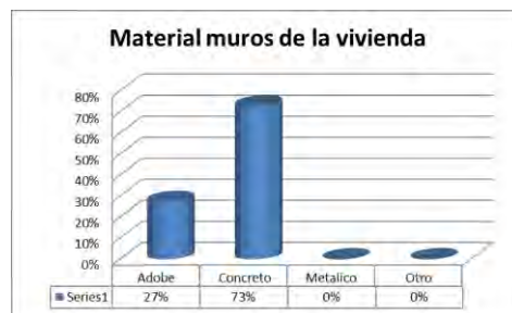
Figura 86. Material muros de la vivienda
