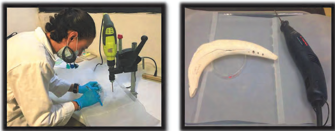
Figura 3.1 Extracción de muestras de tejido óseo mediante taladro y moto-tool.
