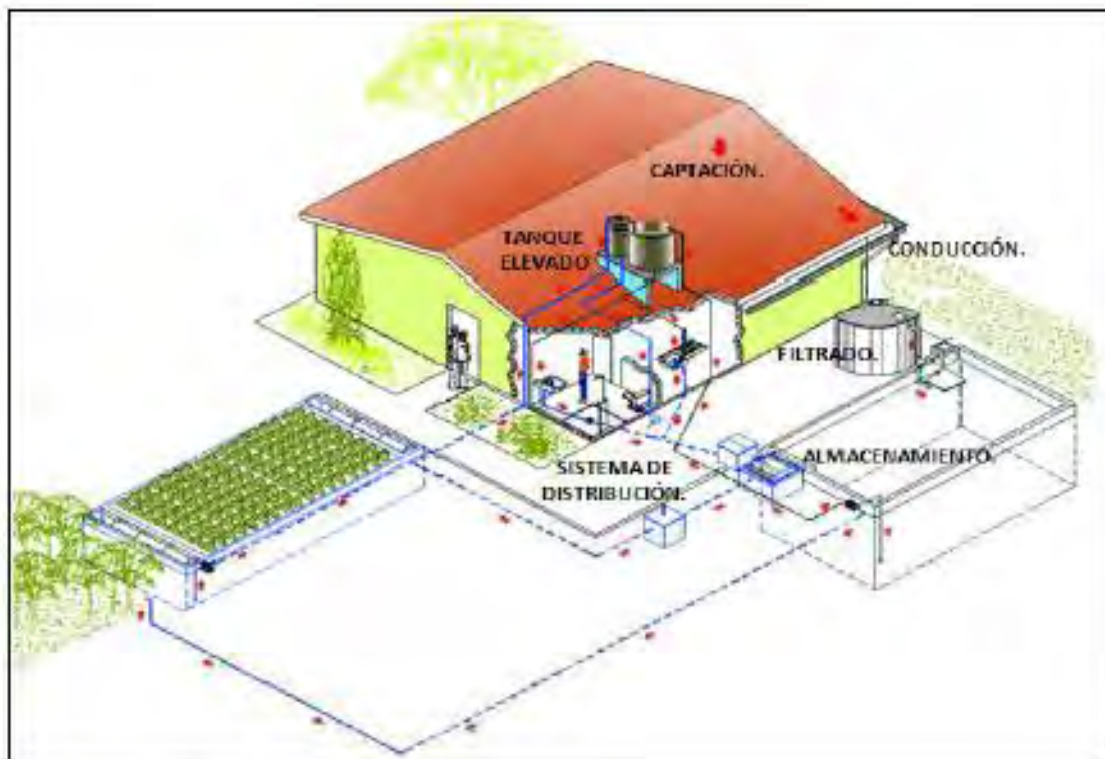
Figura 33: Sistema de captación de agua de lluvia Colpos-1.
