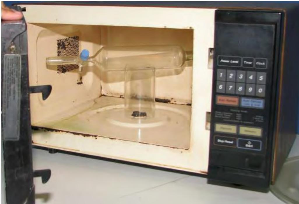
Figura 16. Diagrama de colocación del reactor dentro del horno de microondas [29].
