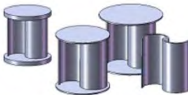
Figura 4.12 Diferentes tipos de tapas en un rotor Savonius [26].
