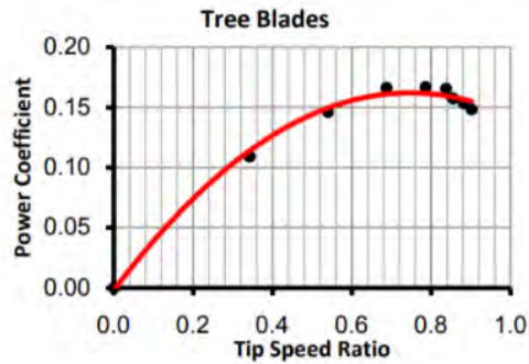
Figura 4.4 La variación del coeficiente de potencia con la relación de velocidad de la punta para una turbina eólica savonius de tres aspas [25].
