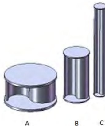
Figura 4.10 Turbinas Savonius con diferentes relaciones de aspecto, (A) Rotor con un diámetro mas que su altura, (B) Rotor con doble altura al diámetro, (C) Rotor con una altura elevado comparado con diámetro [26].
