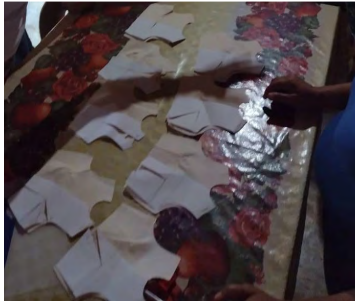
Ilustración 128.-Moldes anatómicos de blusa y sus transformaciones
