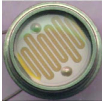
*Imagen 2.11. Ejemplo de una fotocelda o fotorresistencia.*
