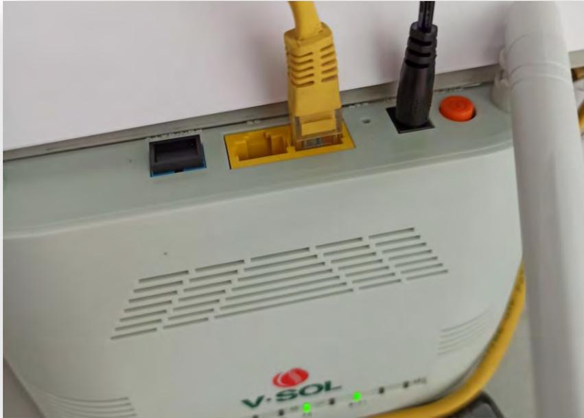
FIGURA 121(CONEXIÓN DE CABLE A LA ONU)
