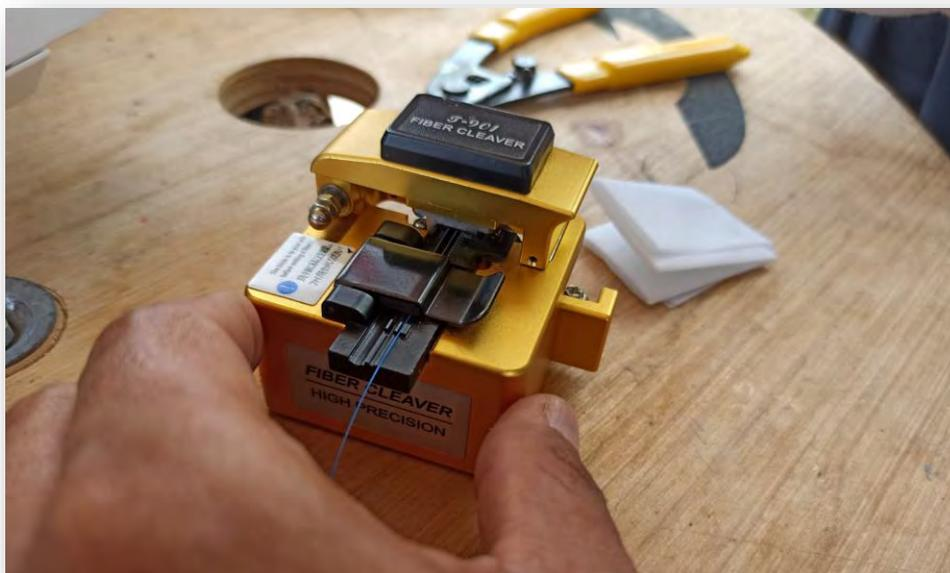
FIGURA 85(CORTE DEL HILO A FUSIONAR)
