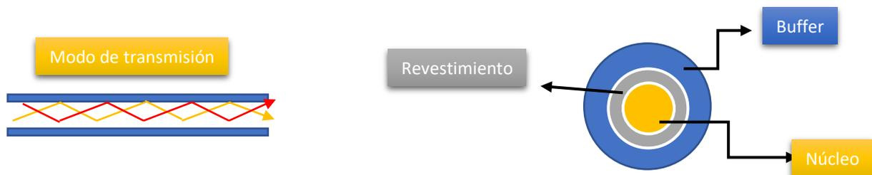
El cable multimodo dispone de un núcleo de mayor diámetro que permite el paso de múltiples modos de luz. Esto significa que se pueden transmitir más tipos de datos.
