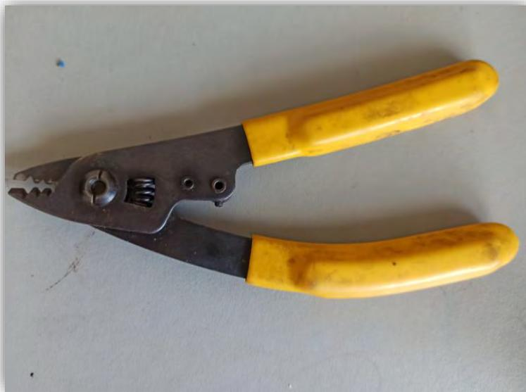
FIGURA 45(PINZAS PARA PELADO)
