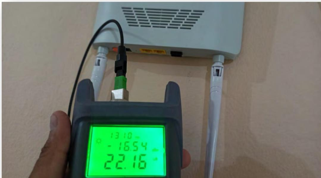
FIGURA 138(MEDICIÓN DE SEÑAL DEL LADO DEL CLIENTE)
