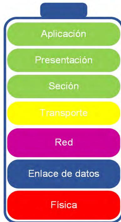
FIGURA 1(CAPAS DEL MODELO OSI)
