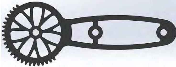
Figura 21 Rediseño de pinza con peso reducido [Elaboración propia].
