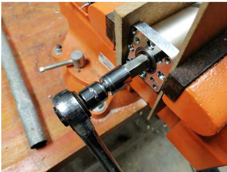
Figura 63 Bloqueo de motor con alimentación de 12 V [Elaboración propia].
