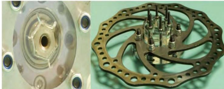
Figura 66 Adaptador del freno, antes y después [Elaboración propia].
