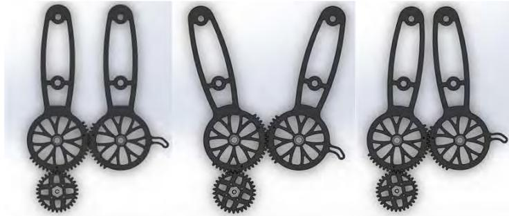
Figura 43 Posiciones de pinzas durante ciclo respiratorio (Inicial  $0^\circ$ , Apertura  $-25^\circ$ , Compresión  $10^\circ$ ) [Elaboración propia].
