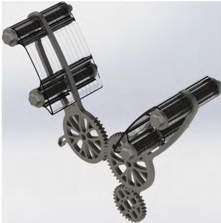
Figura 47 Ensamble de componentes relacionados a la compresión del ambu [Elaboración propia].
