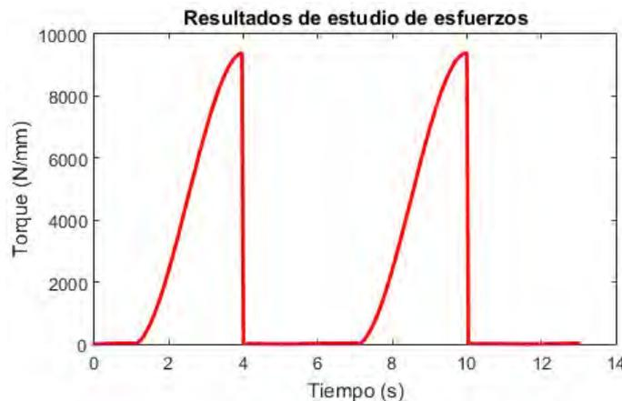
Figura 46 Resultados de torque en motor [Elaboración propia].
