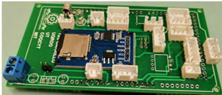
Figura 61 Shield durante ensamblaje de componentes [Elaboración propia].
