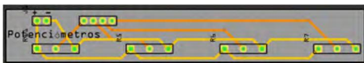
Figura 56 PCB montaje potenciómetros [Elaboración propia].
