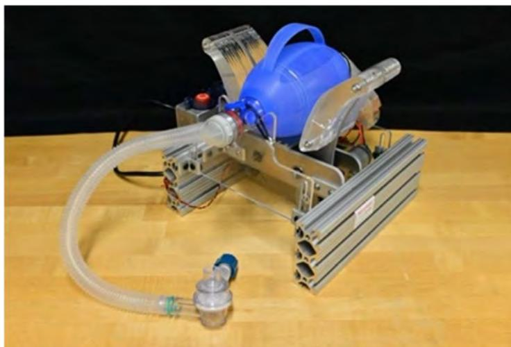
Figura 12 Respirador propuesto por MIT (Massachusetts Institute of Technology, 2020).
