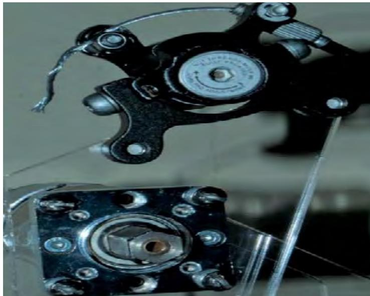
Figura 67 Ensamblaje de pinzas de freno [Elaboración propia].
