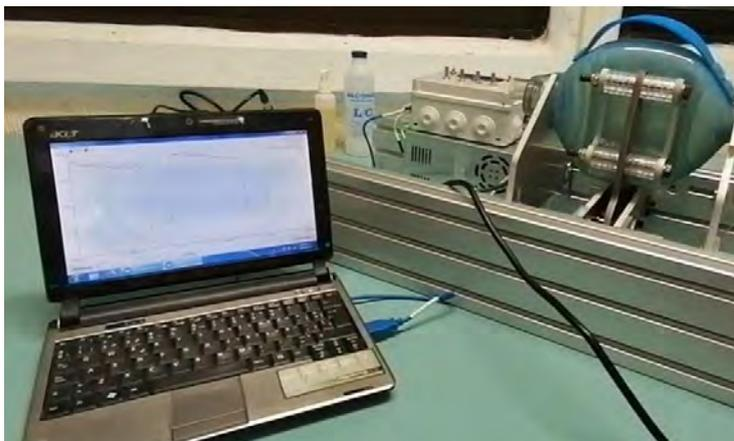
Figura 82 Prototipo final del respirador y gráfico de flujo de aire en pantalla [Elaboración propia].
