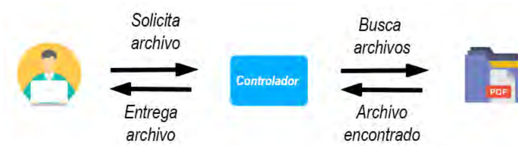
Ilustración 6: Ejemplo del Controlador. Fuente: Elaboración propia.
