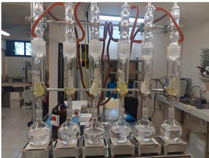
Foto 2: Mostrando el sistema de extracción de Soxhlet para extraer el contenido de grasas del sargazo
