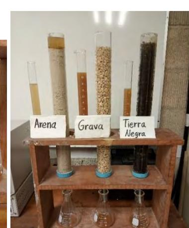
Fotografías: prototipo y experimentación de filtrado, toma de pH y conductividad de los lixiviados. Experimento elaborado en el Laboratorio de Ingeniería Ambiental.
