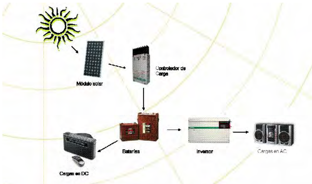
Figura 20. Componentes de un sistema fotovoltaico.
