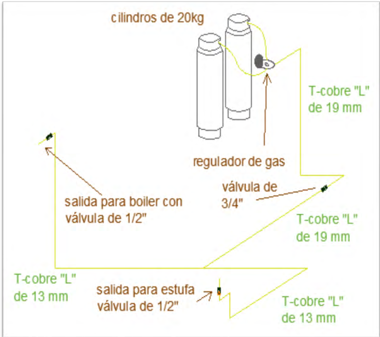
Figura 3.10. Isométrico de la instalación de gas.
