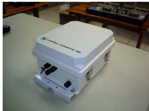
Figura 63. Caja protectora contra el medio ambiente PLV100, con desecador de humedad.
