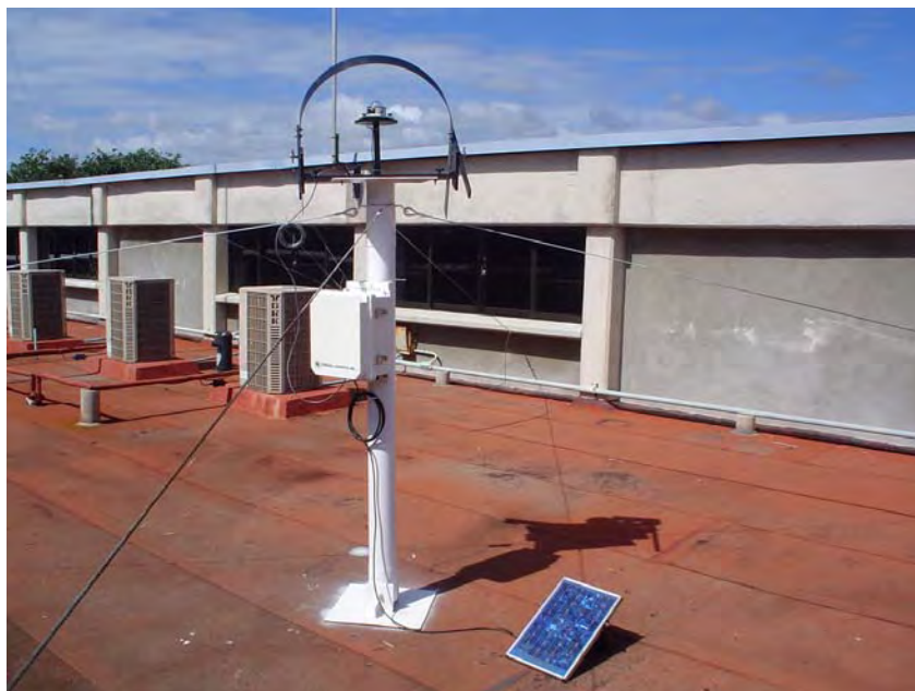
Figura 72. Armado final de la estación Solarimétrica, radiación difusa (BASE 2).
