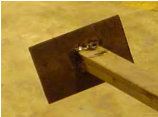
Figura 30. Tabla pequeña de acero par al base del piranómetro.
