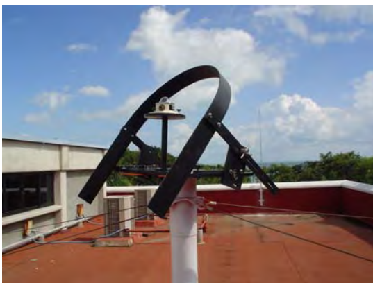
Figuras 56. Piranómetro Eppley 8-48 con banda sombreadora.
