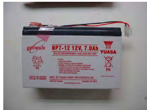
Figura 62. Batería interna del PS100, la cual recibe toda la energía que manda el módulo solar y la almacena.
