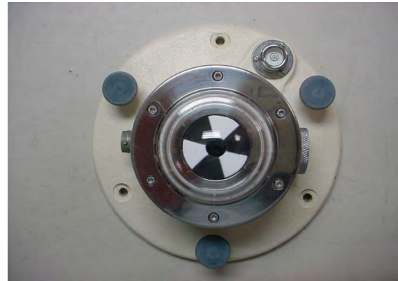
Figuras 55. Piranómetro Eppley 8-48, vista lateral panel izquierdo. Vista superior panel derecho.
