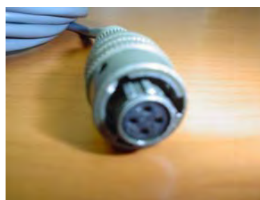
Figuras 57. Cable de conexión del piranómetro al adquisidor de datos.
