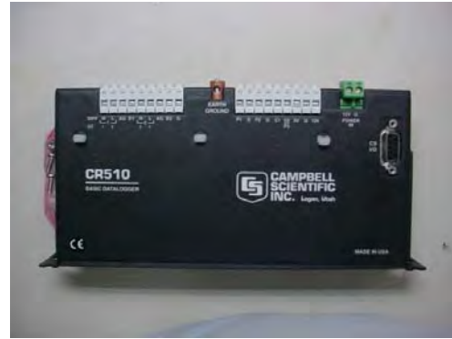
Figura 60. Adquirente de datos marca Campbell Scientific Inc.
