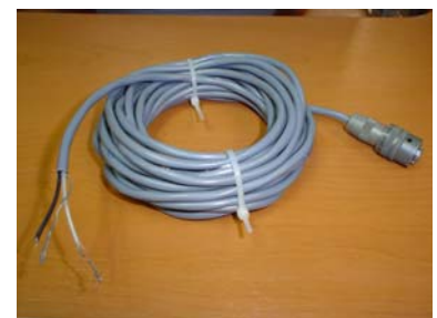
Figuras 57. Cable de conexión del piranómetro al adquisidor de datos.
