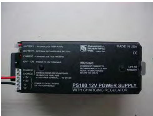
Figura 61. Suministro de energía de 12 V PS100.
