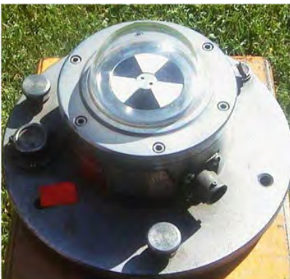
Figura 16. Piranómetro black & white, Eppley.
