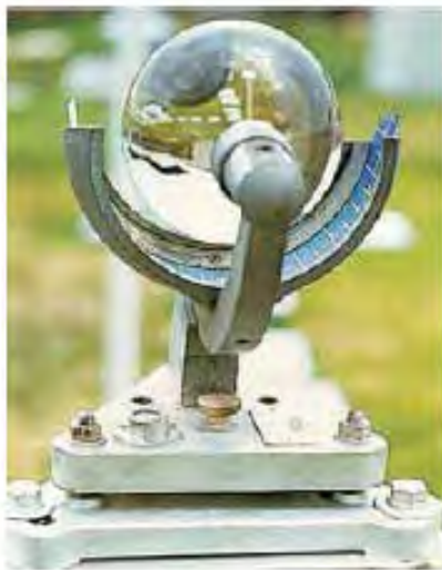
Figuras 22. Distintos modelos de heliógrafos de Campell-Stokes.
