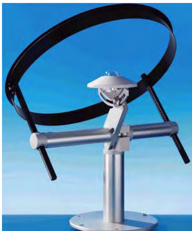
Figura 18. Piranómetro con banda sombreadora.
