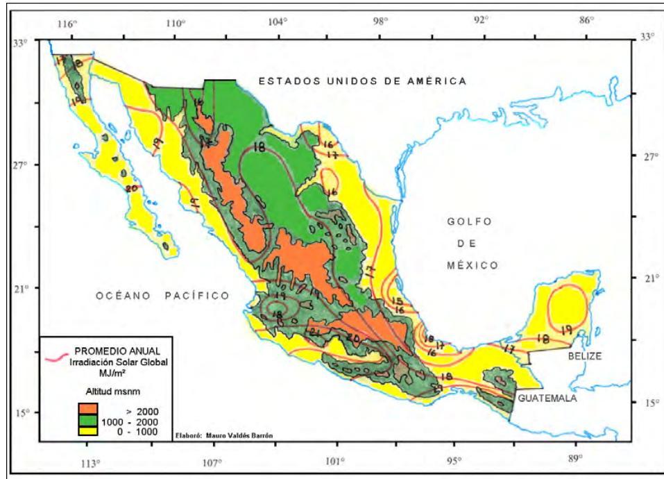
Figura 9. Isolneas de insolución promedio anual para México, en MJ/m 2 /día; adaptado de (Galindo y Valdés, 1992).
