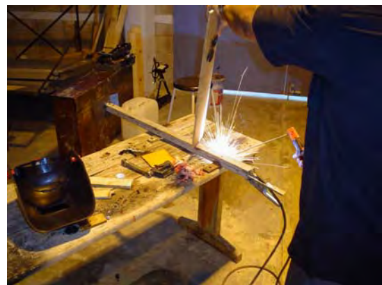
Figura 33. Soldadura de la segunda placa sujetadora.
