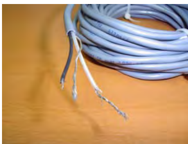
Figuras 57. Cable de conexión del piranómetro al adquisidor de datos.
