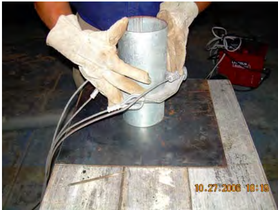
Figura 45. Ajuste del tubo con la tabla de tensores y su base.
