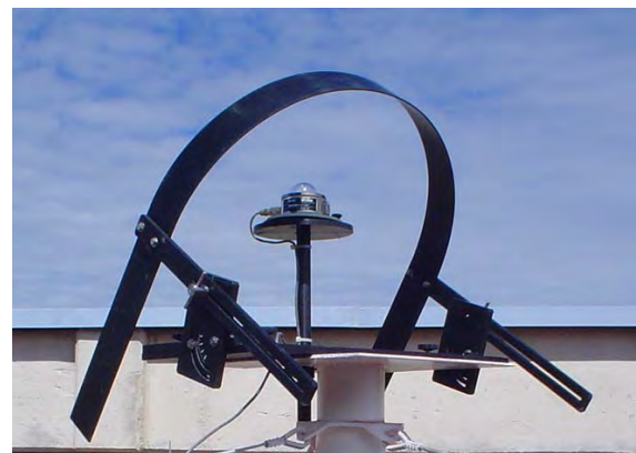
Figuras 56. Piranómetro Eppley 8-48 con banda sombreadora.
