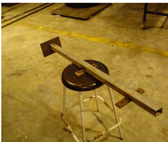
Figura 34. Finalmente que soldada de la Base 1 completamente.
