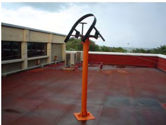
Figura 64. Colocación de la banda sombreadora antes de pintar la Base 2.
