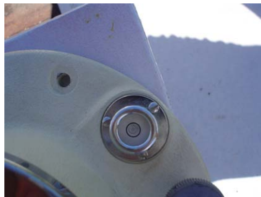
Figura 65. Nivelación de los piranómetros.
