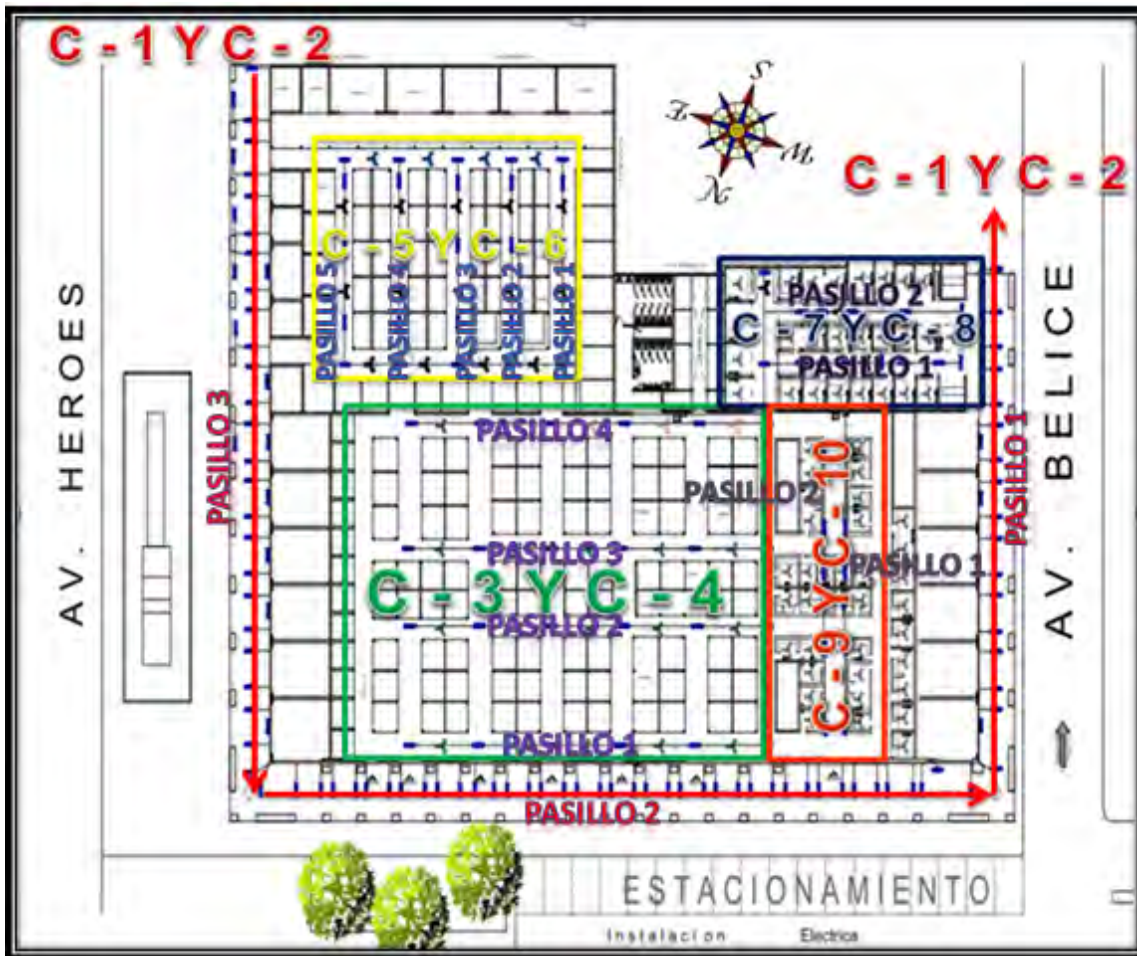
Fig. 44. Planta arquitectónica del mercado y asignación de los circuitos eléctricos en cada pasillo del mercado.
