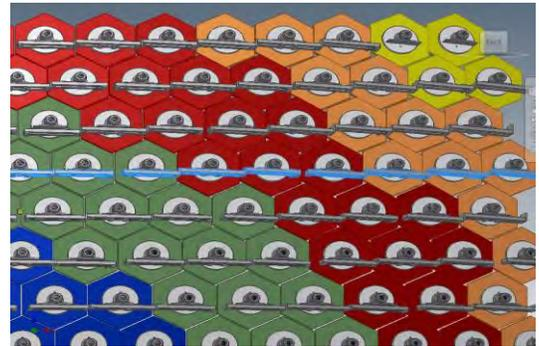
Ilustración 17; Posición espacial de los espejos y ensamble sobre la malla [9]
