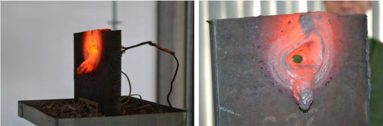
Ilustración 28; Placa de acero al carbón fundida a 1406C° en un tiempo de 525 segundos. [13]
