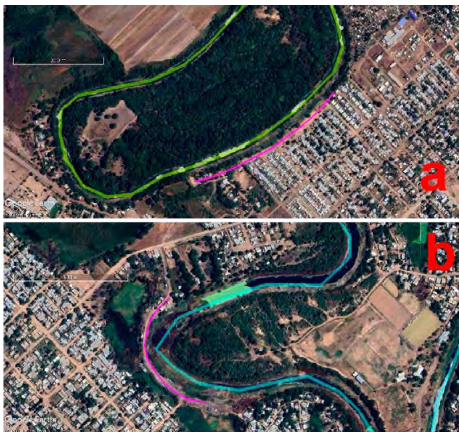
Figura 11: a) Subtramo 1: discontinuidad longitudinal por asentamiento residencial; b) Subtramo 3: discontinuidad por trazado de vías de comunicación
