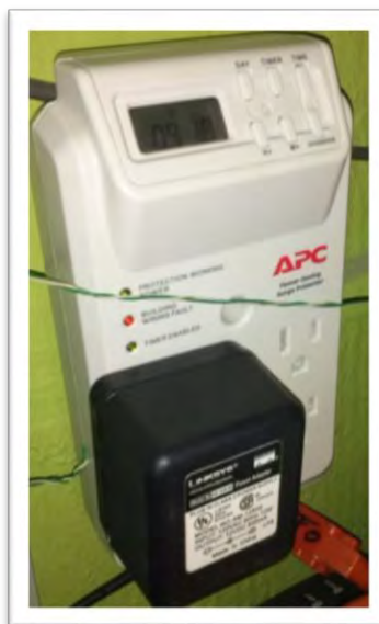
Ilustración 20 Equipo APC encargado de realizar el encendido del equipo Linksys
